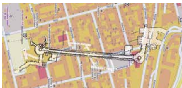
شکل ۸: نقشه تونل پناهگاهی که حفاری آن از دو طرف انجام گردید
